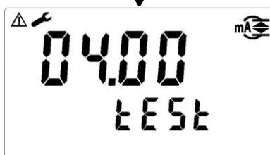
按 或 键, 对输出电流进行测试, 可用电流表检测
